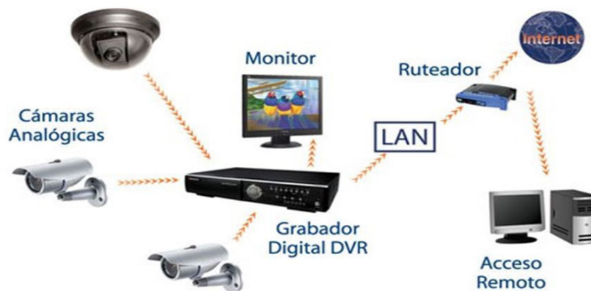
Figura 1. Esquema de equipos de red CCTV.
